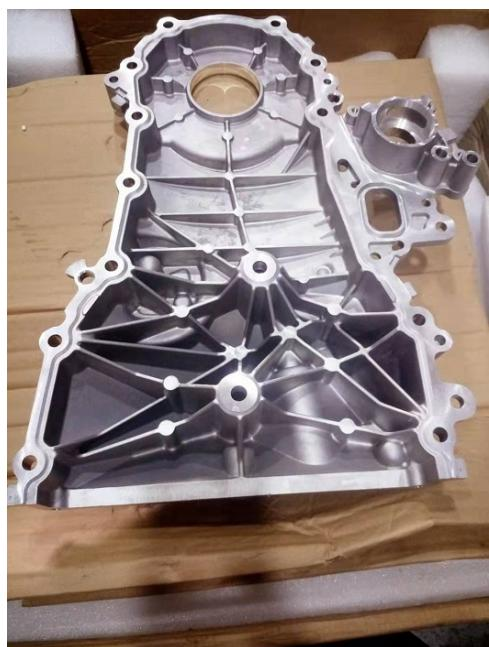
上海昶炫实业有限公司是一家专业做浸渗加工的公司, 主要为客户提供: 1、金属铸件浸渗封孔(解决泄漏问题) 2、粉末冶金制品树脂封孔(解决电镀不良、泄漏、腐蚀等问题) 3、多孔性材料的改性处理(导电性、物性、耐性改良等) 在压铸件及粉末冶金件制造过程中, 由于气体残留、晶体收缩等原因, 不可避免地形成大量微孔、砂眼、裂纹, 微孔渗漏给机器设备的使用带来一系列问题, 即使用于无压力要求的用途也可能因电镀, 涂漆及其它表面处理时电镀液, 酸液等进入零件内部导致内部腐蚀, 缩短了零件使用寿命, 因微孔的存在使表面喷漆、电镀等形成气泡或凹凸不平。如何很好的密封铸件微孔是铸件行业的一大难题 浸渗处理对您的重要性。淮安自动浸渗上海昶炫不仅拥有领先地位的技术和产品, 而且不断为用户提供各方面的解决方案与服务。
