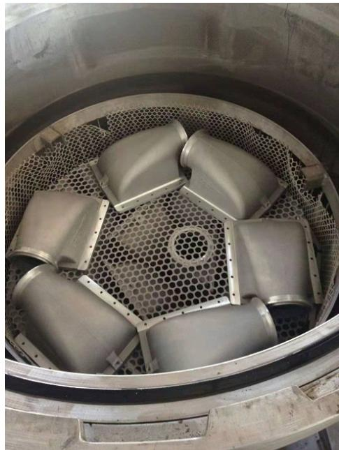
浸渗设备该如何保养随着浸渗设备使用的越来越\*\*\*，市场的需求也在增加。采用先进的浸渗工艺，可使零部件的设计薄壁化，可承受高压至零件爆裂，使以往需要返工的比例降到最小。生产成本也降低了。那么浸渗设备该如何保养呢？请看下文：1、制冷机在室温大于25℃时打开，日夜不能关闭。2、制冷机在每天工作时关闭，下班时打开。3、储液罐内胶液必须淹没制冷盘管。4、真空泵油\*\*\*次用1个月后必须更换，以后每2个月更换一次。5、整套设备必须使用清洁的压缩空气。6、清洗缸和热水固化罐内的水必须定期更换。7、制冷空调每年使用时必须查验一次。8、浸渗罐密封圈必须常年有一根备用。9、汽缸定期加润滑油。10、浸渗罐斜块定期涂黄油。11、热水固化罐重新加水后必须把PH值调整到5左右。12、每天工作前打开隔离罐底的阀门，排放废液，10分钟关闭。以上12点就是对浸渗设备的维护，浸渗设备和其他设备一样，用久了都是要维护的，不然就会出现问题，导致不能正常工作。
